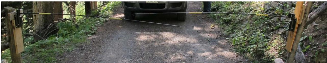
Abbildung 5: Weidetor, welches von Fahrzeugen ohne Aussteigen passiert werden kann und sich nach dem Öffnen selbstständig wieder schliesst.
