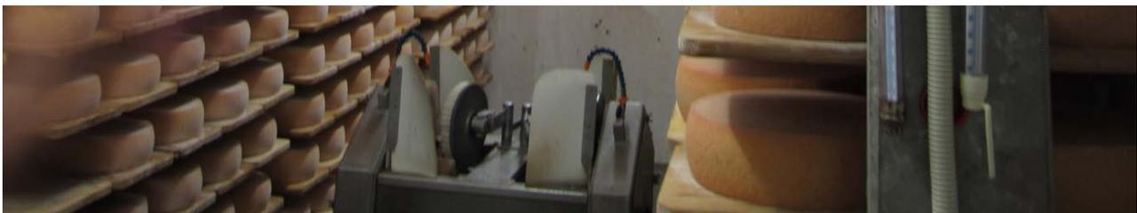
Abbildung 37: Käseschmiermaschine im Käsekeller.
