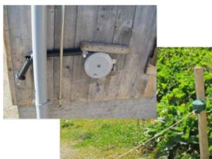
*Abbildung 3: Selbstaufrollvorrichtungen für Weidezäuntore*
