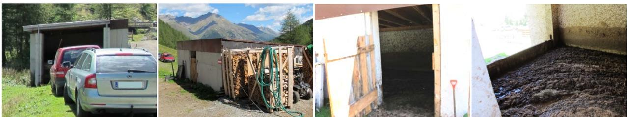
Abbildung 28: Kombination zwischen Melkstandgarage und Mistlager: Im Winter dient das Bauwerk als Garage für den mobilen Melkstand. Im Sommer wird darin Mist gelagert. Dieser wird über Holzbohlen in der Garagenzufahrt zurückgehalten.
