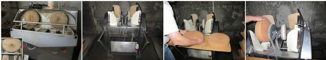
Abbildung 36: Einsatz von Käseschmiermaschinen (zwei Ausführungen; links aussen und links Mitte): Die Käse werden mit den Käsebrettern aus dem Regal genommen (rechts Mitte) und einzeln von Hand in die Käseschmiermaschine eingelegt (rechts aussen). Es können zwei Laibe gleichzeitig geschmiert werden.
