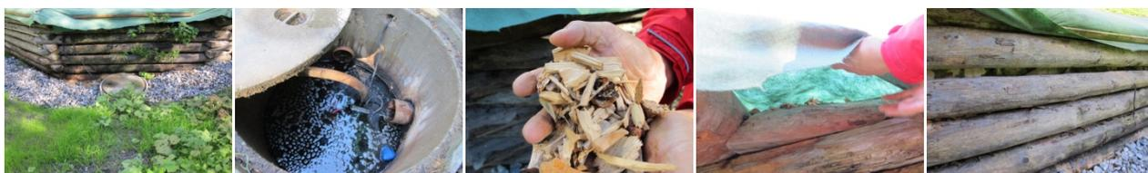
Abbildung 41: Details der Schottenkompostieranlage: Lage des Kontrollschachtes (links aussen), geöffneter Kontrollschacht (links Mitte), Holzschnitzel aus der Schottenkompostieranlage (Mitte), Blick unter die Abdeckung (rechts Mitte) und zwischen die Hölzer der Wand (rechts aussen).
