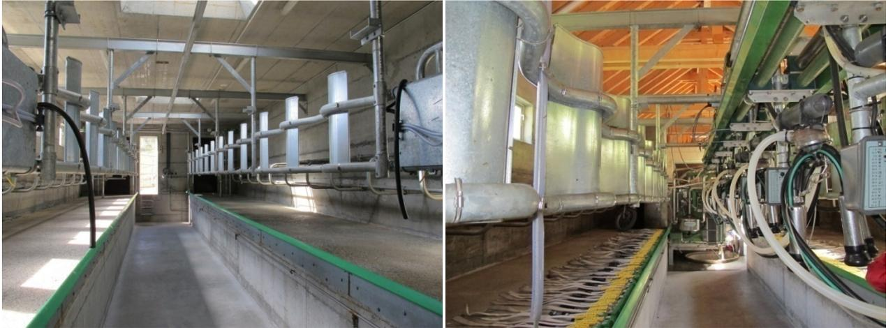
Abbildung 32: Mobile und in 2 x 4 und 2 x 8 trennbare 2 x 12 Swing-Over Melkanlage zum Einsatz an drei Standorten (links: Melkstand ohne Melkanlage, rechts: Melkstand mit Melkanlage).
